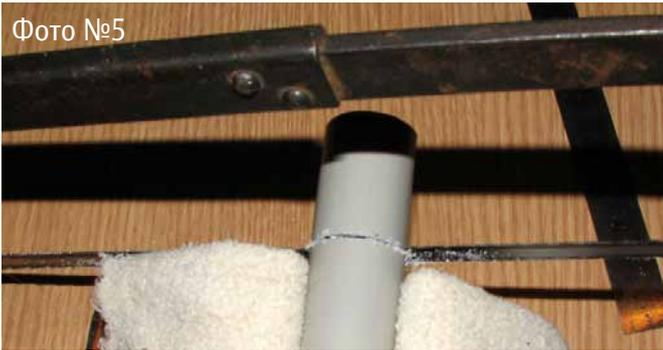
Используя тиски и тряпочку и перчатки (не стирается маркер), отпиливаем в два приема, прокручивая трубу вокруг оси (фото №5). Получается более аккуратно – поэтому и разметка по всему диаметру.
