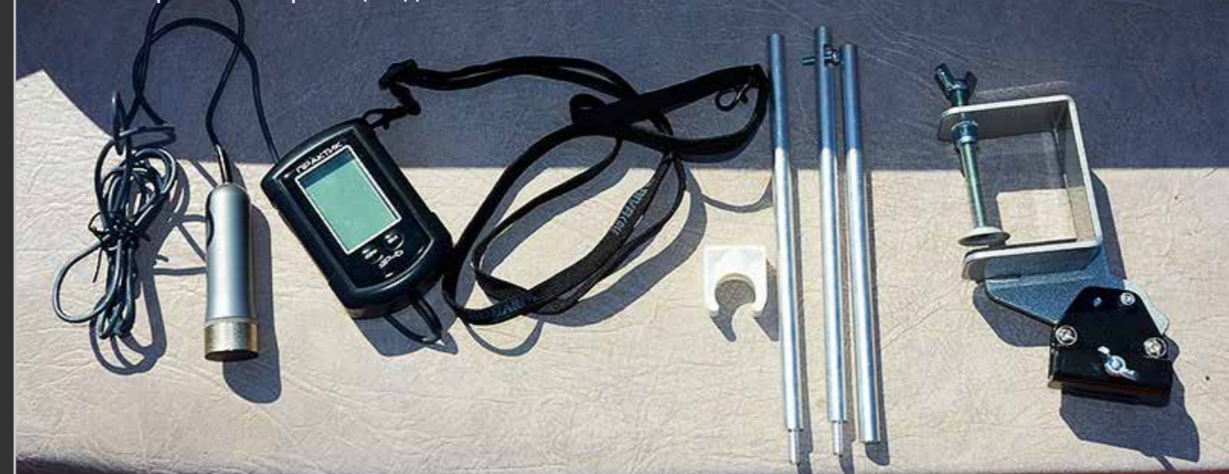
Эхолот и крепеж на транец лодки
